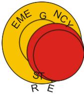
**Appuyer sur le bouton d'arrêt d'urgence ne fait remonter que la plaque chauffante. L'alimentation électrique et l'air comprimé ne sont pas interrompus. Risque d'accident !**
