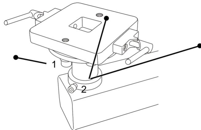
Si la feuille téflon du plateau chauffant est endommagée, elle doit être remplacée. Eteignez l'appareil et assurez-vous que la plaque chauffante est froide. Dévissez les 4 vis (1) et vous enlevez les 2 tiges tenant la feuille de téflon. Changer la feuille PTFE et percez 4 petits trous dans le téflon PTFE pour fixer à nouveau le téflon comme avant.
