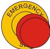
Appuyer sur le bouton d'arrêt d'urgence, ne fait remonter que la plaque chauffante. L'alimentation électrique et l'air comprimé ne sont pas interrompus. Risque d'accident !
