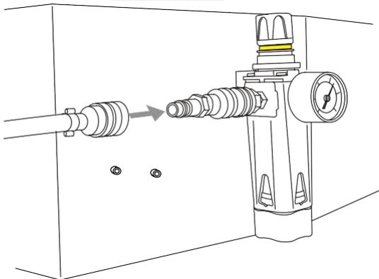
La connexion au tuyau pneumatique amènera immédiatement la plaque chauffante. Risque d'accident !
