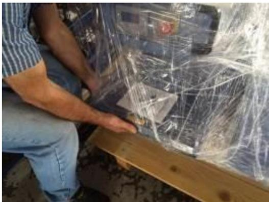
Si la presse est trop lourde, retirez le film de protection et branchez-la. Appuyez sur le bouton Marche/arrêt pour faire monter le plateau chauffant. Retirez le plateau chauffant et le plateau inférieur afin de diminuer le poids de la machine.
